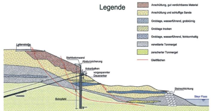
Der Querschnitt zeigt den Aufwand für die Sanierung. Entlang der roten Linien findet die Rutschung statt.
